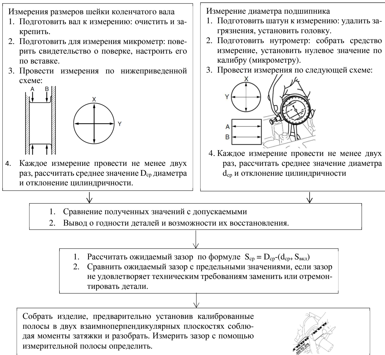
Рисунок 2. Схема определение зазора в паре шатун – коленчатый вал
