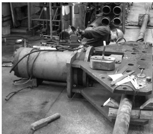
Рисунок 3. Правка трубогибом сплошной заготовки для изготовления трубы \varnothing 146 \times 43 \times 10000 мм глубоким сверлением
