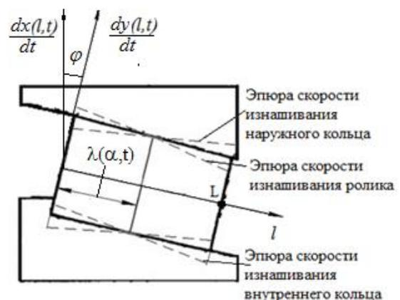
Рисунок 3. Эпюры скоростей износа элементов РПК в момент времени  $t$
