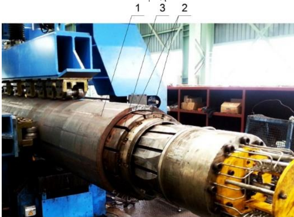
Рисунок 1. Экспандер в процессе деформации трубы, на трубном заводе компании Tianjin Yuantai Derun Pipe Manufacturing Group Co., Ltd (Китай)
