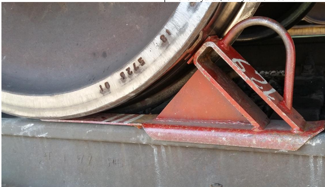
Рисунок 3. Инновационный тормозной стояночный башмак во время испытаний на станции Лосиноостровская Московской железной дороги
