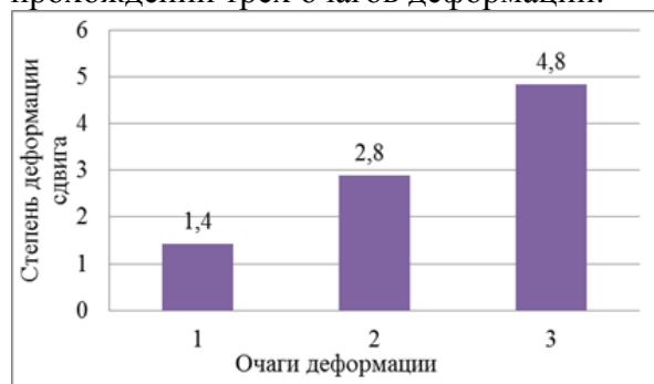
Рисунок 4. Диаграмма величины накопленной степени деформации сдвига при прохождении трех очагов деформации
