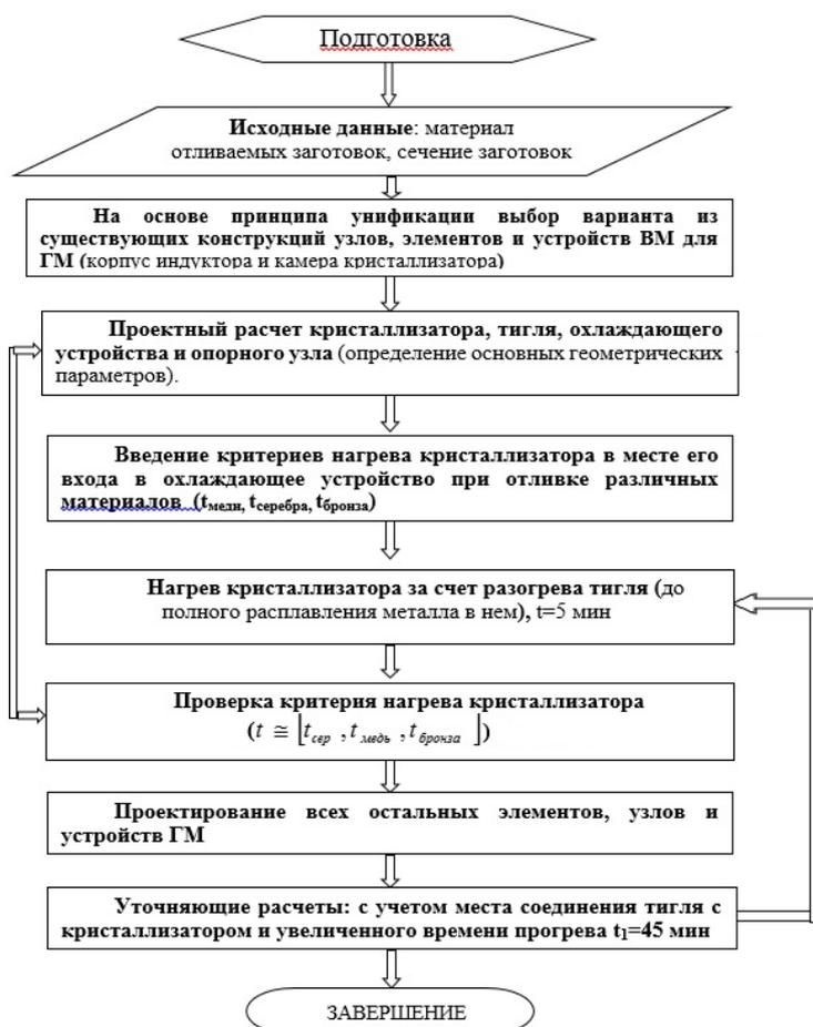
Рисунок 3. Упрощенная схема алгоритма проектирования кристаллизатора ГМПЛЗ
