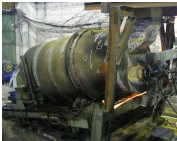
Рисунок 1. Ротационная наклоняющаяся печь:
