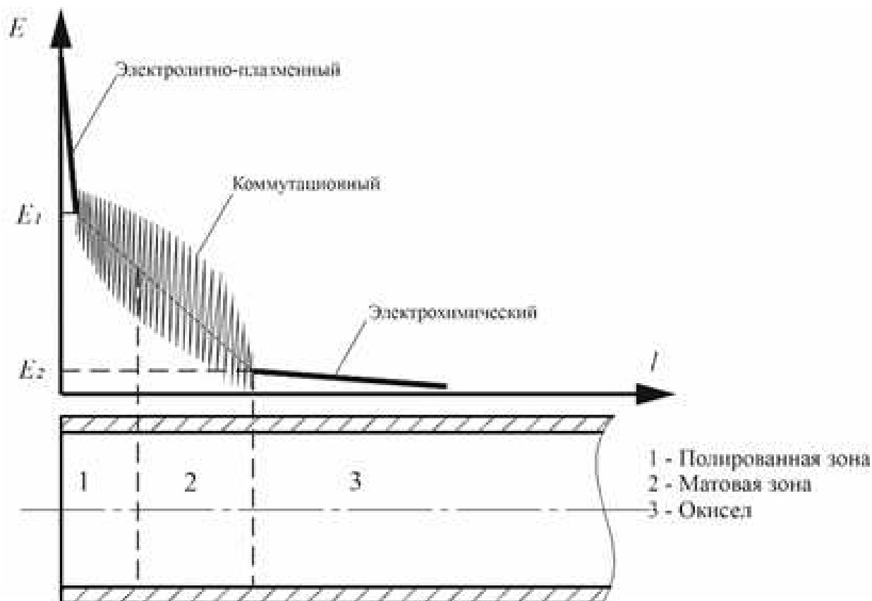
Рисунок 9. Связь пороговых значений напряженности электрического поля с границами характерных зон внутренней поверхности
