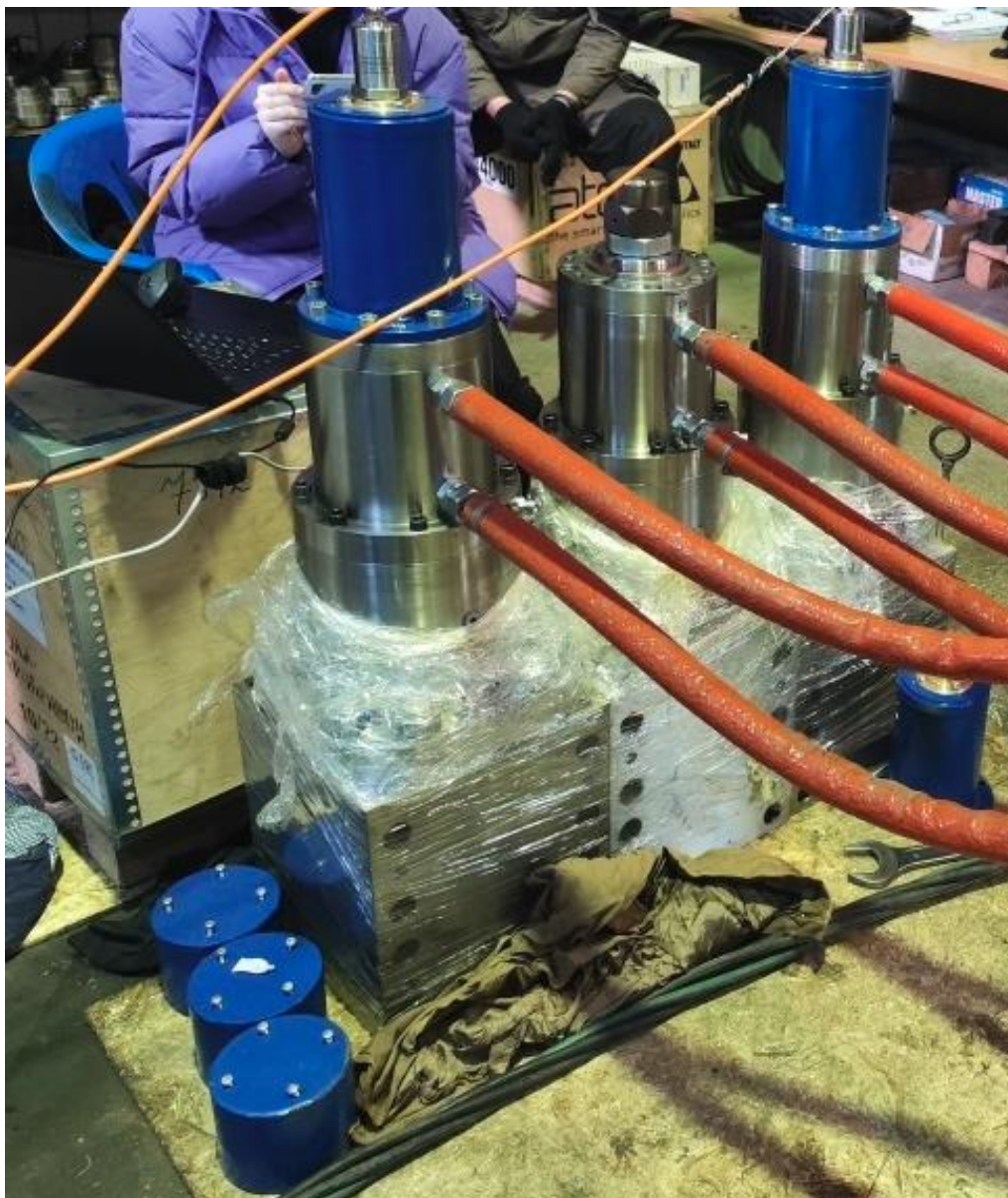
Рисунок 4. Проверка динамических характеристик работы клапанных модулей с пропорциональным управлением и с условным проходом 80 мм для главного гидрораспределителя штамповочного пресса усилием 1000 МН, эксплуатируемого в ПАО «Русполимет» (г. Кулебаки), на участке испытаний готовой продукции УриЦ
