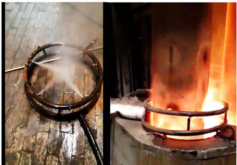
Рисунок 4. Опытно-промышленная установка испарительного охлаждения
