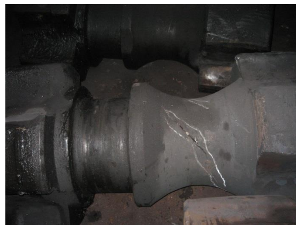
Рисунок 4. Брехшпиндель пильгерстана 6÷12" (усталостная трещина, косой излом)
