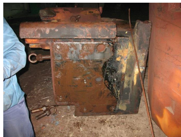
б) «разбивание» и выкрашивание наделок подушек рабочих валков
