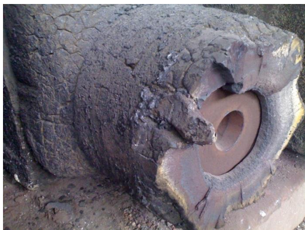
Рисунок 3. Хобот завалочной машины мартеновского цеха
