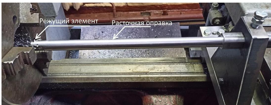
Рисунок 4. Общий вид расточной оправки, установленной на станке
