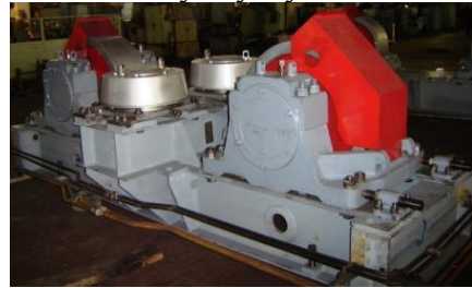
Рисунок 6. Упорная станция для фиксации барабана грохота
