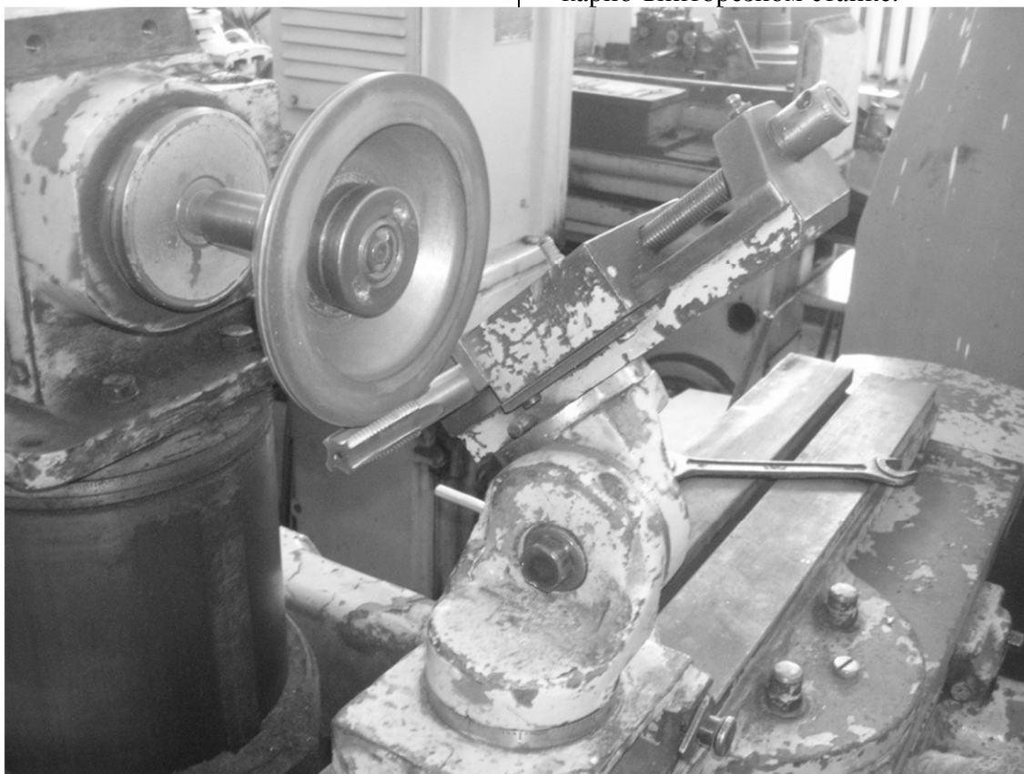
Рисунок 1. Переточка метчика на заточном станке
