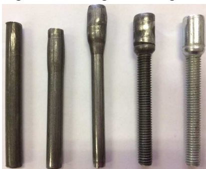
Рисунок 6. Технологический процесс изготовления резьбового наконечника троса
