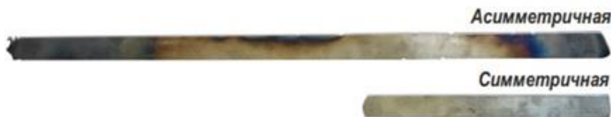
Рисунок 3. Образцы после асимметричной и симметричной прокатки за один проход
