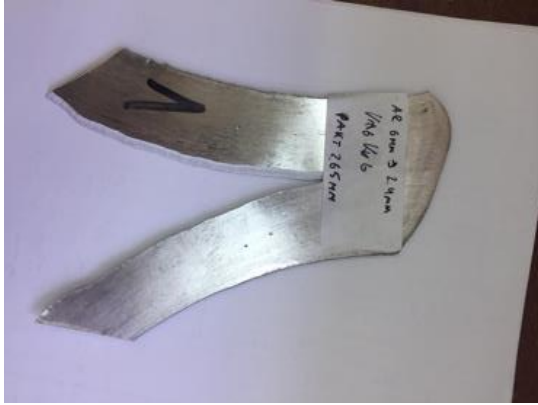
Рисунок 4. Вид разрушенного при симметричной прокатке образца
