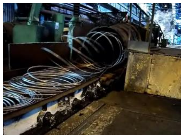
Рисунок 9. Существующая технология. Негативное влияние остаточных упругих напряжений кручения в прокате на укладку витков (арматурная сталь №10 класса А500)
