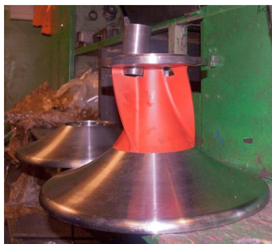
Рисунок 5. Примеры различных модификаций конструкции виткоформирующей головки
