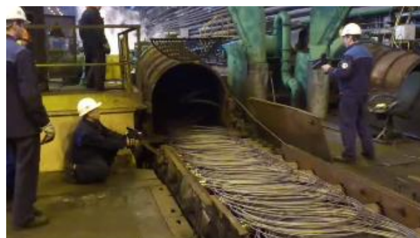
Рисунок 11. Новая технология. Качественная укладка термоупрочненной арматурной стали №10 класса А500 при оптимальном угле перекоса роликов трайб-аппарата
