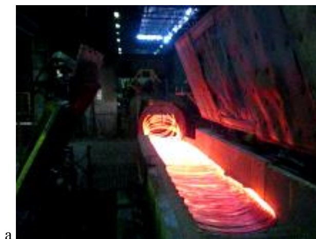
Рисунок 7. Фото промышленных испытаний при скоростях прокатки до 102 м/с
