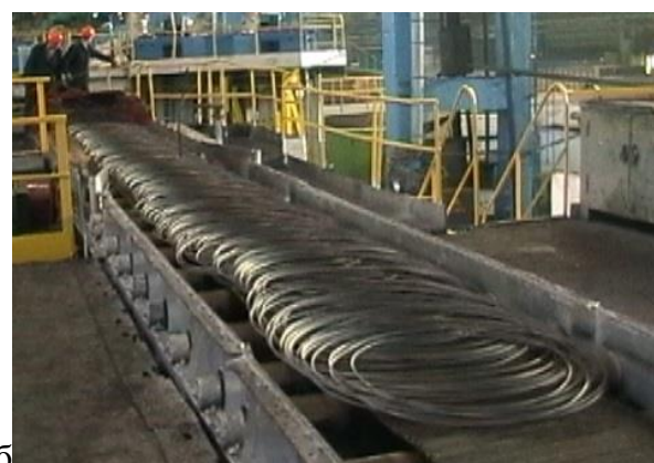
Рисунок 6. Фото промышленных испытаний при скоростях прокатки до 60 м/с: а – намотка горячего проката, б – формирование витков переменного диаметра
