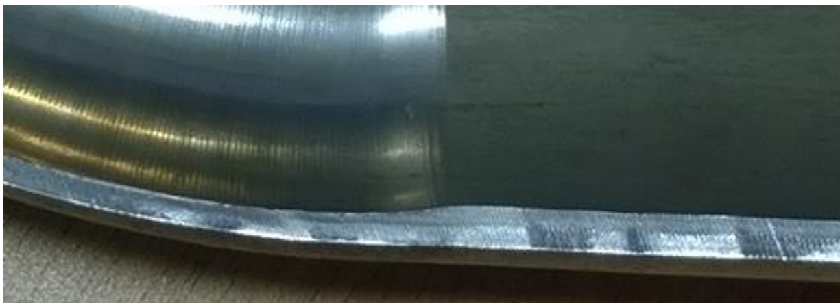
Рисунок 10. Фото продольного сечения изогнутой трубы из стали марки 12Х18Н10Т
