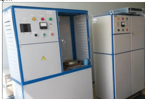
Рисунок 2. Магнитно-импульсные установки МИУ-2 и МИУ-3
