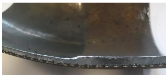
Рисунок 5. Дефект внутренней стороны трубы в концегиба
