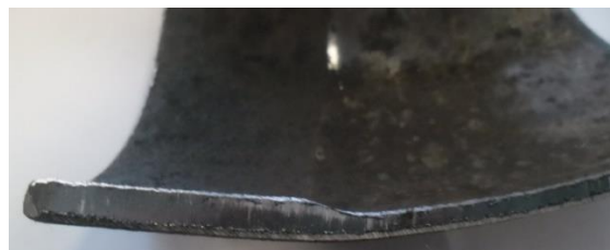
Рисунок 4. Дефект внутренней стороны трубы в началегиба
