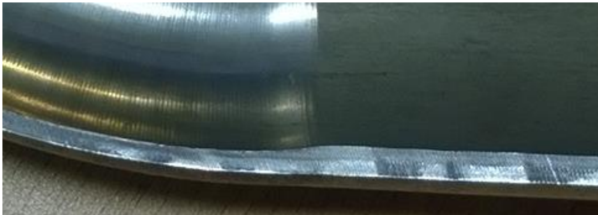
Рисунок 10. Фото продольного сечения изогнутой трубы из стали марки 12X18H10T
